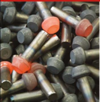
**ELETTROSTAMPATI E STAMPATI A CALDO IN QUALSIASI TIPO DI ACCIAIO PER INGRANAGGERIA, TIRANTERIA, ALBERAME E PARTICOLARI SPECIALI A DISEGNO**
